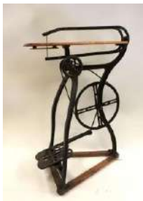
609. Machine à scier les placage en métal et bois, actionnement par pédale actionnant une roue. H. 89 cm.
